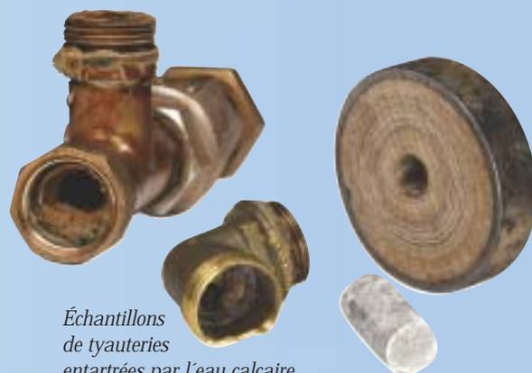
Échantillons de tuyauteries entartrées par l'eau calcaire
